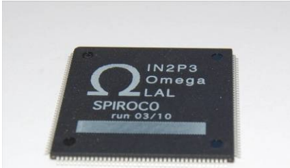
TQFP: height=1.4 mm
