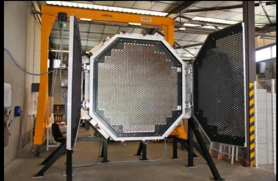
1 camer afor H.E.S.S.2 3000 kg, 2,2x2,4 m 2 1920 PMT
